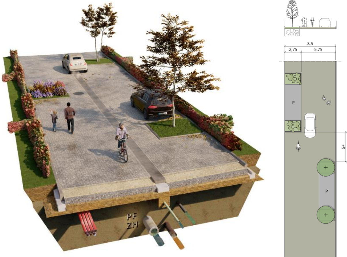
Abb. 43: Beispiel einer Mischverkehrsfläche. Insbesondere in reinen Wohngebieten können auf Mischverkehrsflächen alle Fahrzeuge, Radfahrenden und Fußgänger gemeinsam geführt werden. Und obwohl es hier keine klaren räumlichen Trennungen gibt, kann die Breite des Straßengrundstücks unterschiedlich breit ausfallen, je nach Stellplatzbedarf, geplanter Straßenbegrünung und unterirdischer Infrastruktur (© Planungsbüro Fischer und Zick-Hessler Ingenieure 2023)
